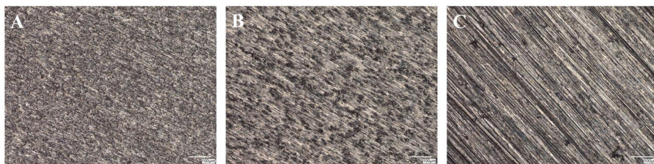
Rysunek 1. Struktura tytanu Grade 2, gdzie do obróbki wykończeniowej użyto: (A) papieru ściernego o gradacji P2000, (B) papieru ściernego o gradacji P1200 oraz (C) papieru ściernego o gradacji P220
