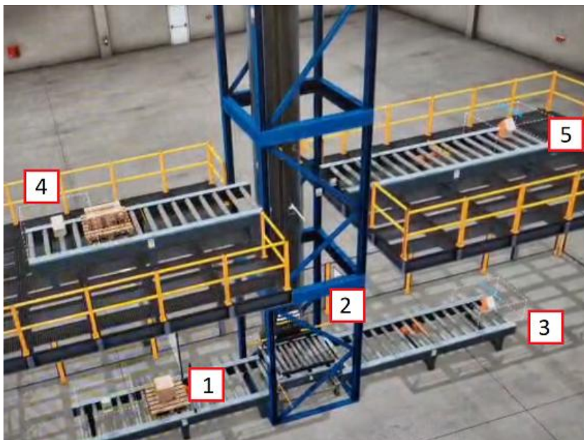
Rysunek 8. Scena windy segregującej paczki w Factory I/O
